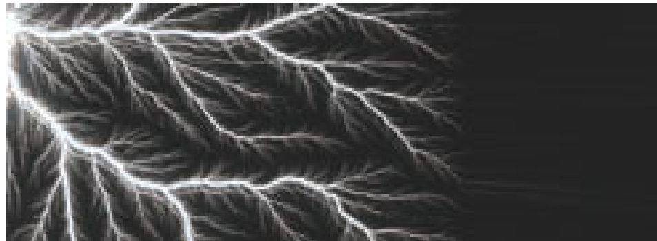
Ausbildung eines leitfähigen Pfades auf oder in Isolationsmaterialien (Quelle: CMC)
